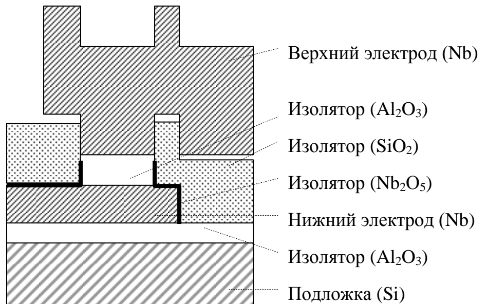
Рис.4. Четвертый этап процесса изготовления тестовой интегральной схемы: процесс «взрыва», нанесение фоторезиста, напыление Nb
